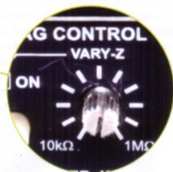
JDV MK3 : la façade comprend un potentiomètre d'adaptation d'impédance, de 10 kΩ (un clavier, par exemple) à 1 MΩ (guitare passive).
